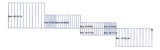
Load 9 : Shear Y : Displacement Force - kN
